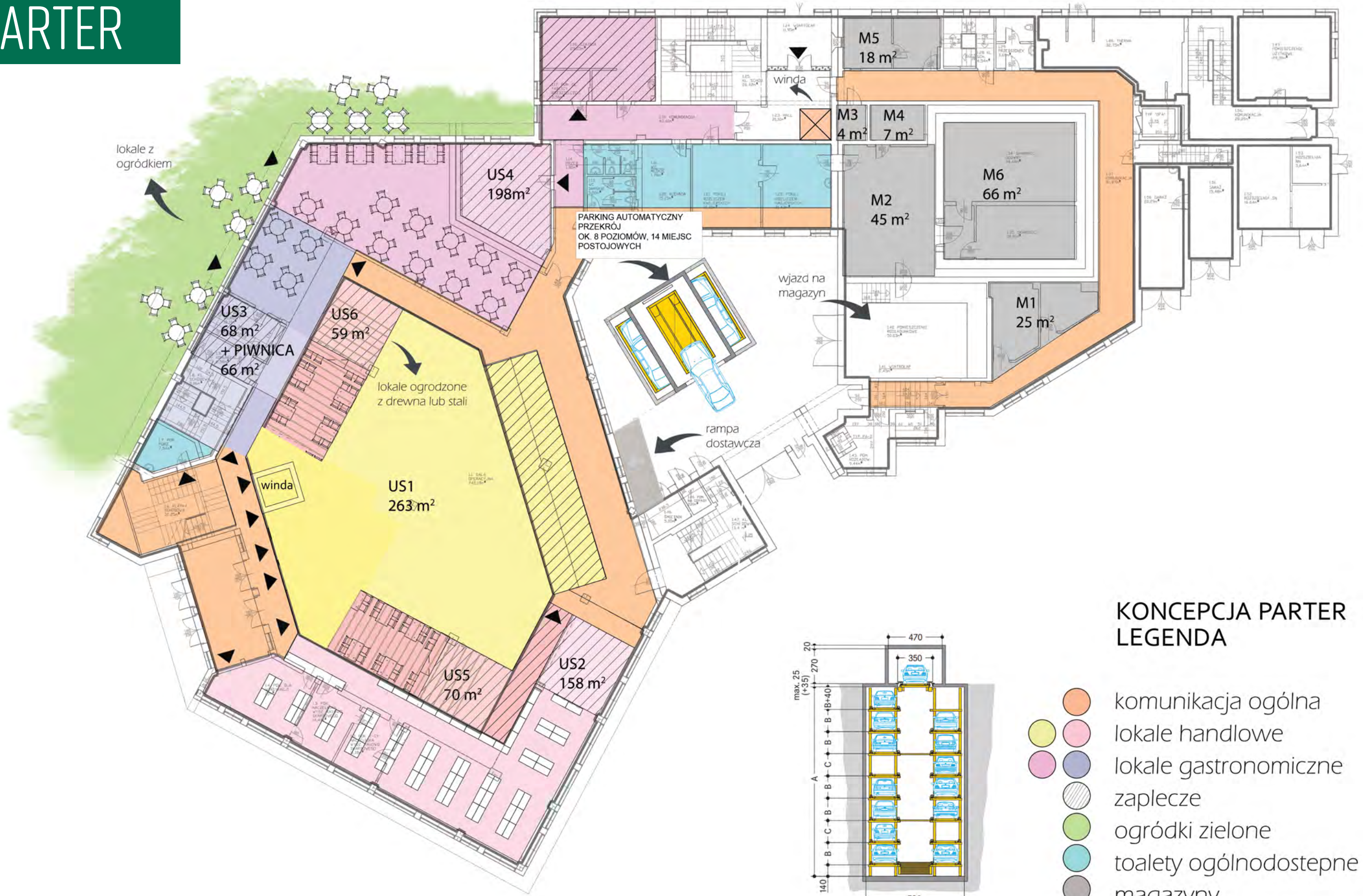
PARKING AUTOMATYCZNY PRZEKRÓJ OK. 8 POZIOMÓW, 14 MIEJSC POSTOJOWYCH
